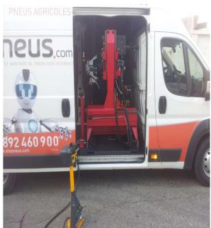
Das Fehlen von endothermen Hilfsmotoren an Bord des Fahrzeugs ermöglicht es Ihnen, den Kraftstoffverbrauch während der Reifendemontagephasen erheblich zu senken.
